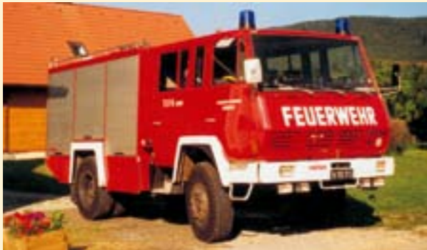
Tanklöschfahrzeug 2000 auf Steyr Fahrgestell
